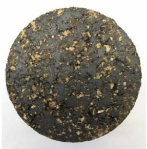
(d) Marshall compacted specimens (60°C)
