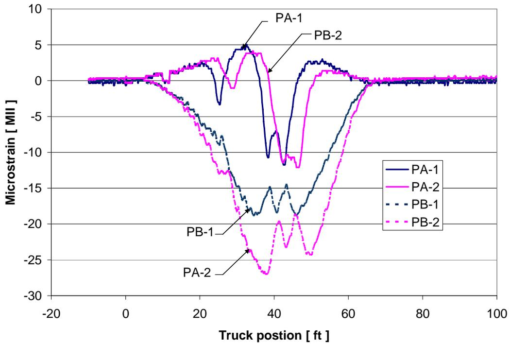
Figure 28. FRP Deck Strains: Path Y2 – 2004 Test
