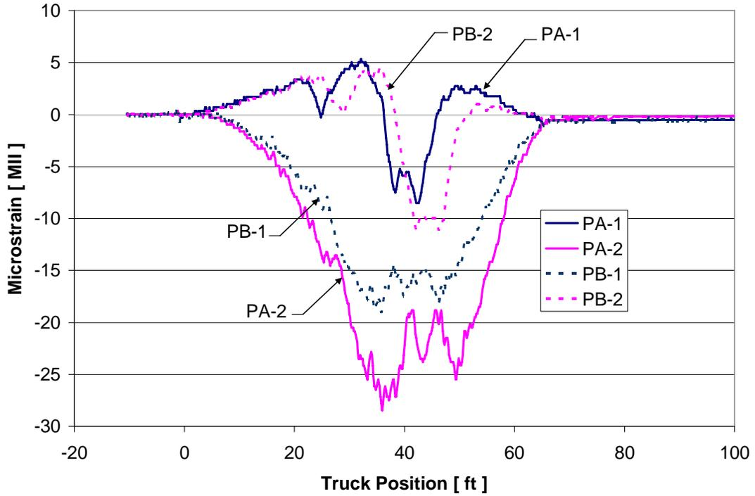
Figure 27. FRP Deck Strains: Path Y2 – 2003 Test
