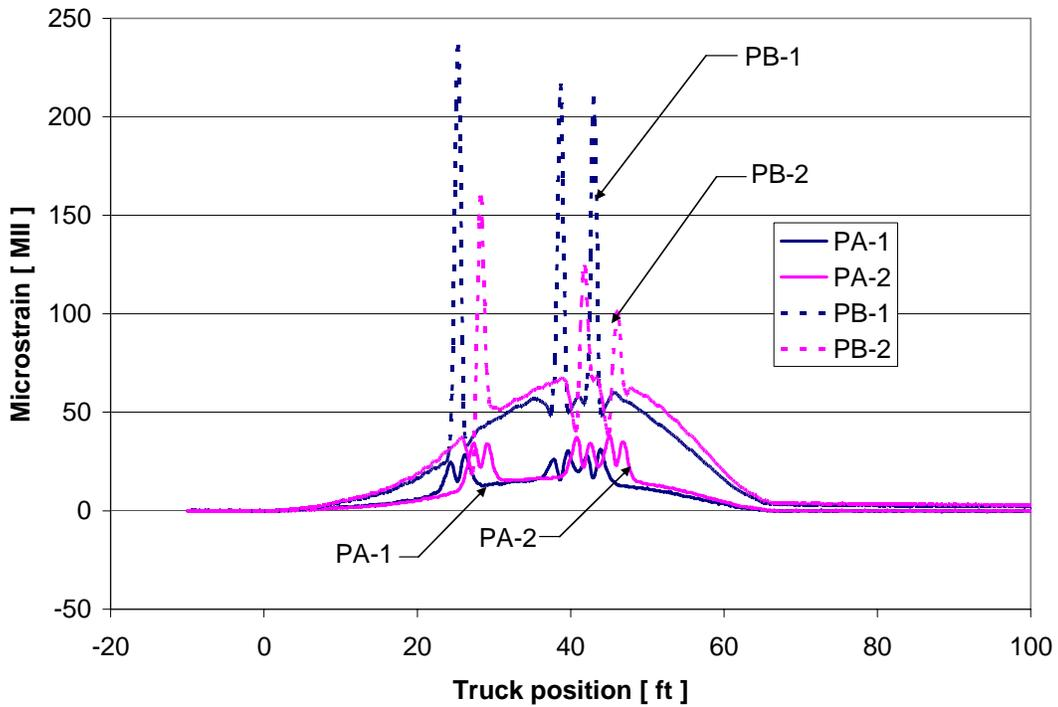
**Figure 30. FRP Deck Strains: Path Y4 – 2004 Test**
