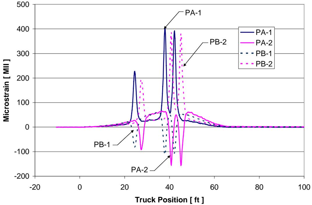
**Figure 29. FRP Deck Strains: Path Y3 – 2003 Test**
