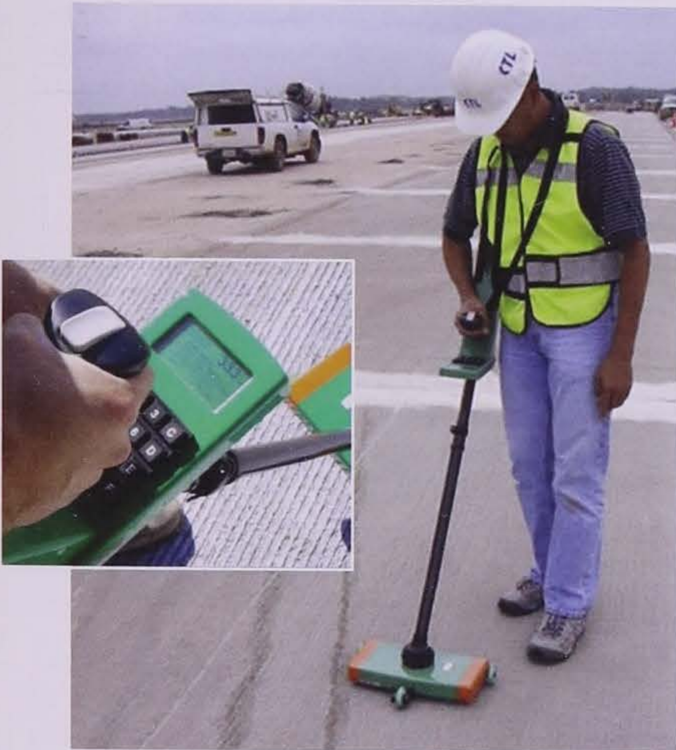
Figure 3.15. MIT Scan T2 device (Ye and Tayabji 2009)
