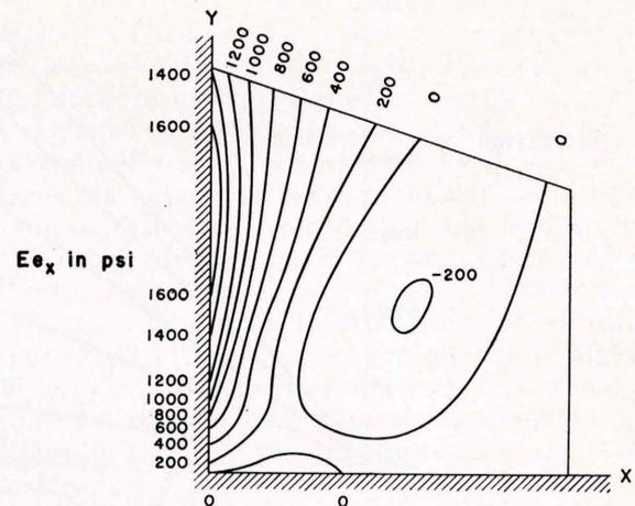
Fig. 24.  $E_{e_x}$  contours for  $p_f = 1$  psi.
