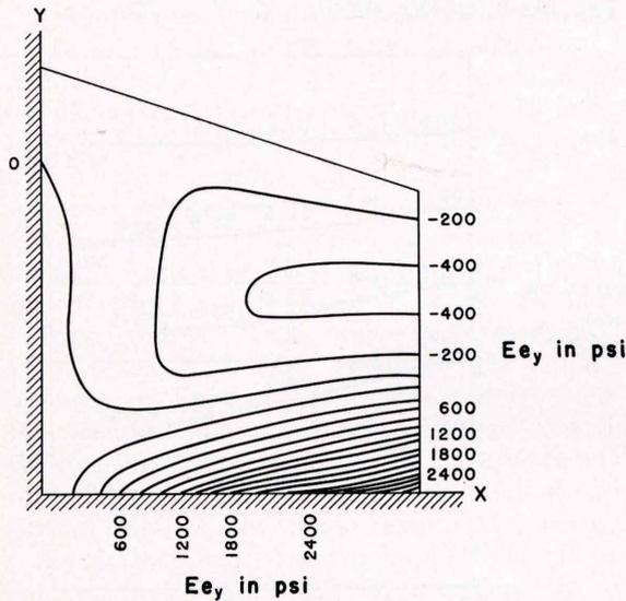
Fig. 25.  $E_{e_y}$  contours for  $p_f = 1$  psi.
