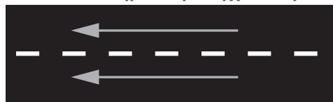
Δρόμος μονής κατεύθυνσης
