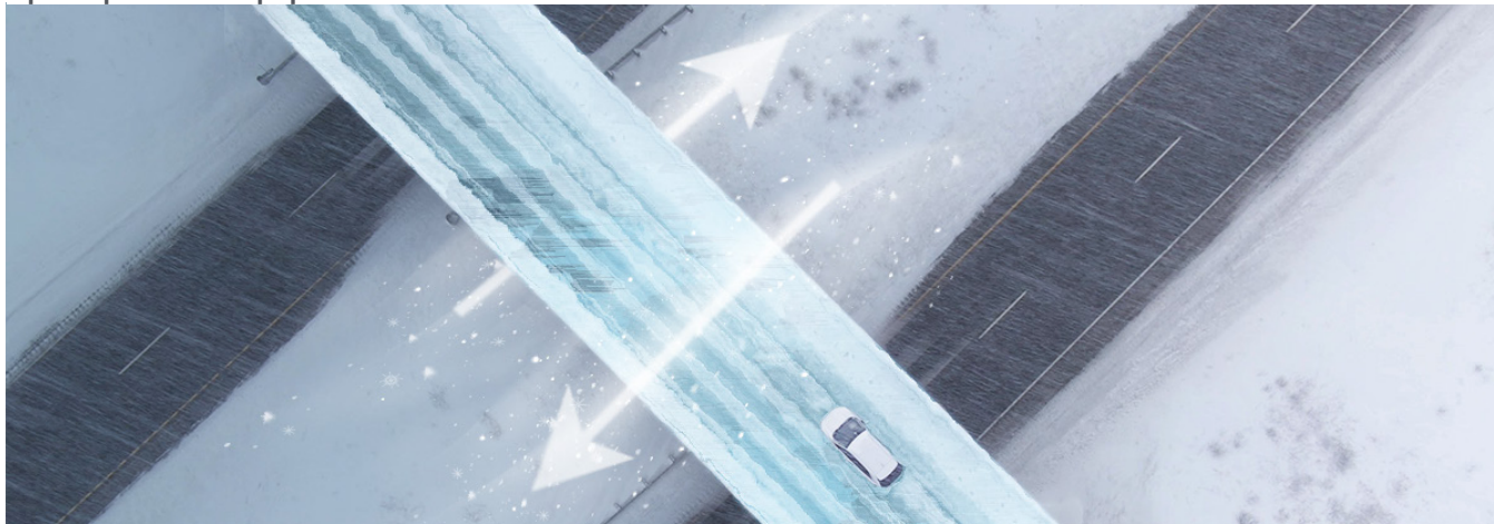
Εικόνα 5.9: Ο πάγος σχηματίζεται πρώτα στις γέφυρες λόγω του αέρα που κυκλοφορεί τόσο πάνω όσο και κάτω από την επιφάνεια του δρόμου.
