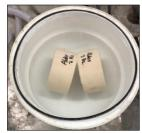
(d) Slices left immersed in water for  $18 \pm 2$  hours
