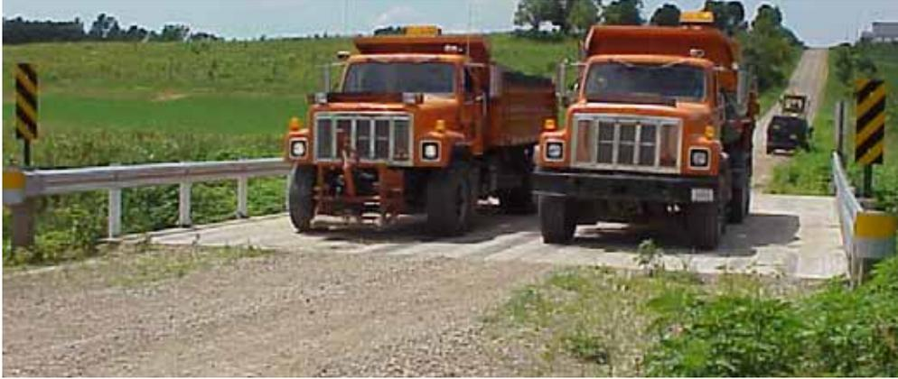
a. Static load test
