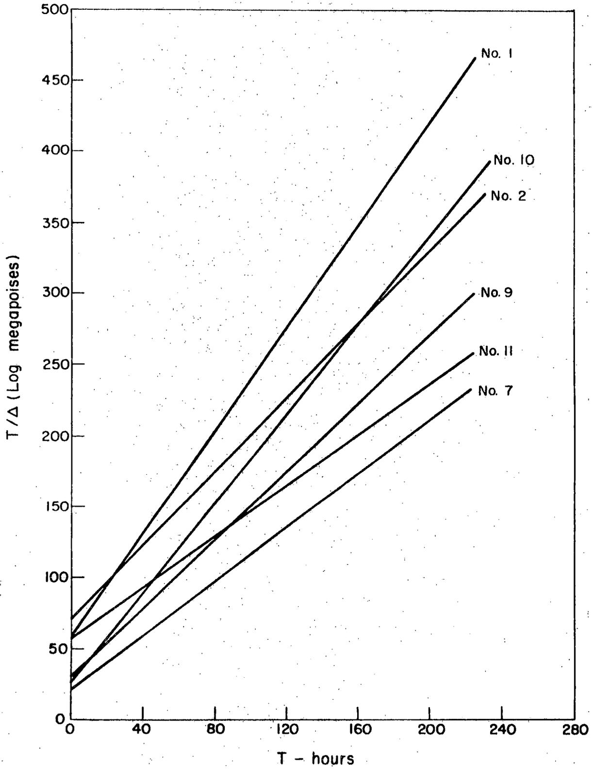
Fig. 3.  $T/\Delta$  log viscosity vs  $T$ .
